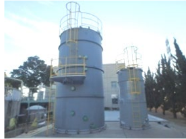
食品系バイオマスのバイオガス化実証事業 （技術開発・実証・FS）→商用化
